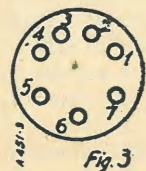
Zoccolo dell'octaodo A K 1 visto inferiormente. - 1 catodo, griglia 6 e metallizzazione; 2, 3 elementi d'accensione; 4 griglie 3 e 5; 5 griglia 1; griglia 2; 7 anodo. Il cappellotto al vertice dell'ampolla è collegato alla griglia 4.
